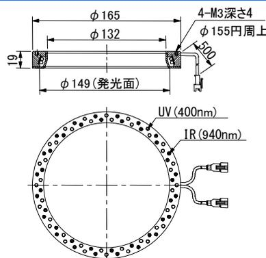
紫外(400nm)と、赤外(940nm)のLEDをちどりに実装した2波長リング照明です。
