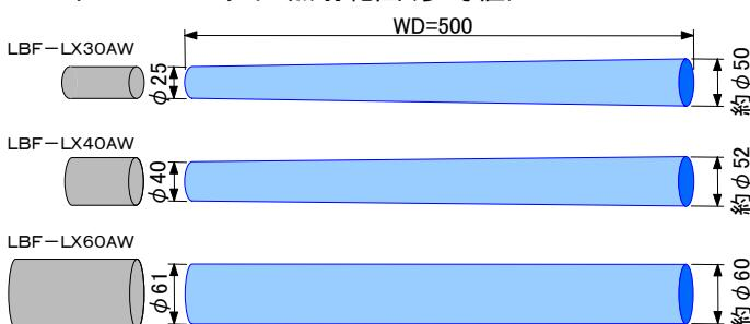
通常の光源は距離の二乗に反比例して光は減衰します。例えば距離が2倍になると光量は1/4になりますが明るく照射することができません。しかし、LBFは疑似平行光なのでこの公式にはあてはまらず距離が伸びても光の減衰を抑えて遠くまで照射可能です。
